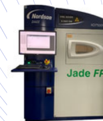
X-Ray檢查機： 檢測BGA等隱藏焊點品質
